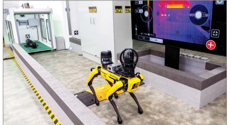
보스턴 다이내믹스의 4족 보행 로봇 ‘스팟’이 공장의 설비 상태를 점검하고 있다. /현대자동차그룹
