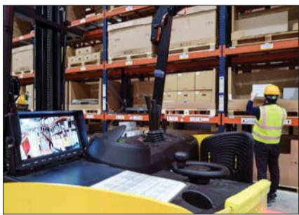
시설 내 곳곳에 설치된 모션센서를 통해 지게차와 작업자의 이동을 실시간으로 인식한다.
