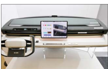
현대모비스가 개발한 콕핏모듈은 탑승객의 감정에 따라 실내 조명을 바꿔주고, 터치만으로 수납 공간인 클로브박스를 자동으로 열 수 있다.
