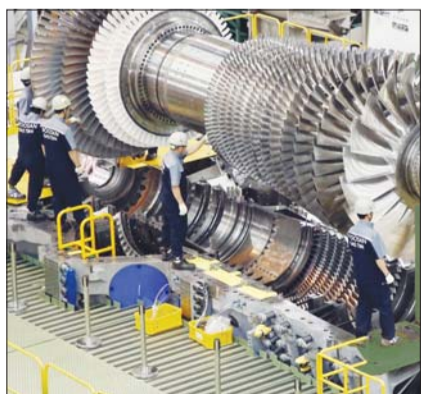
지난 2019년 9월 두산에너지빌리티 직원들이 가스터빈 초도호기 최종조립을 위해 로터 블레이드 케이싱에 설치하고 있다. /두산에너지빌리티
