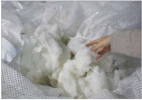
119레오는 방화복에서 해체한 아라미드 펠릿을 설비(가운데 사진)에 넣고 신제품의 90~95% 성능을 갖춘 리사이클링 아라미드 단섬유를 뽑아낸다.
