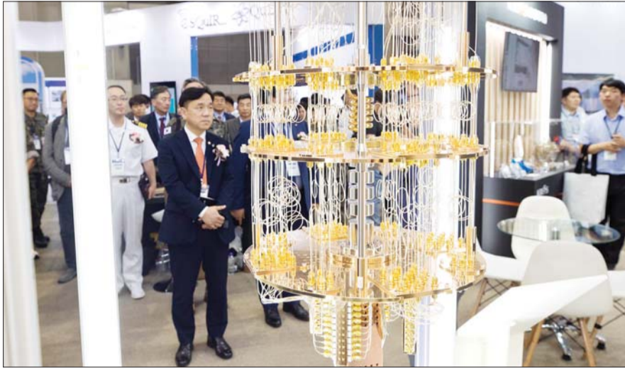
강도현 과학기술정보통신부 제2차관이 지난 6월 경기도 고양시 일산서구 킨텍스에서 열린 '민관군 양자정보협의체 출범식'에 참석해 퀀텀코리아, 한국표준과학연구원 전시관에서 이용호 한국표준과학연구원 박사로부터 '초전도 기반 50큐비트 양자컴퓨터'에 대한 설명을 듣고 있다. /뉴스시스
