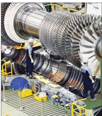
지난 2019년 9월 두산에너지빌리티 직원들이 가스 터빈 초도호기 최종조립을 위해 로터 블레이드를 케이싱에 설치하고 있다. /두산에너지빌리티
