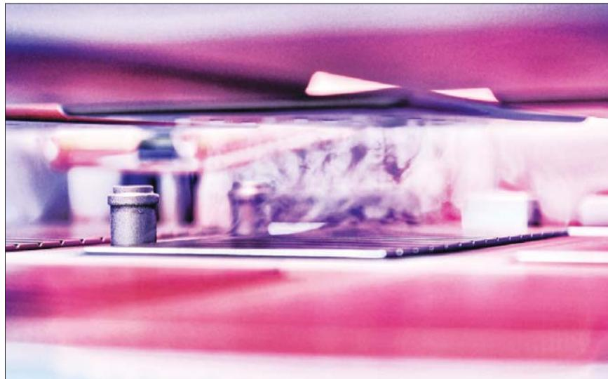
현대모비스가 열폭주를 방지하기 위해 개발한 배터리시스템 모형에서 분사된 소화약제가 셀 가라 앉으며 화재를 진압하는 모습.
