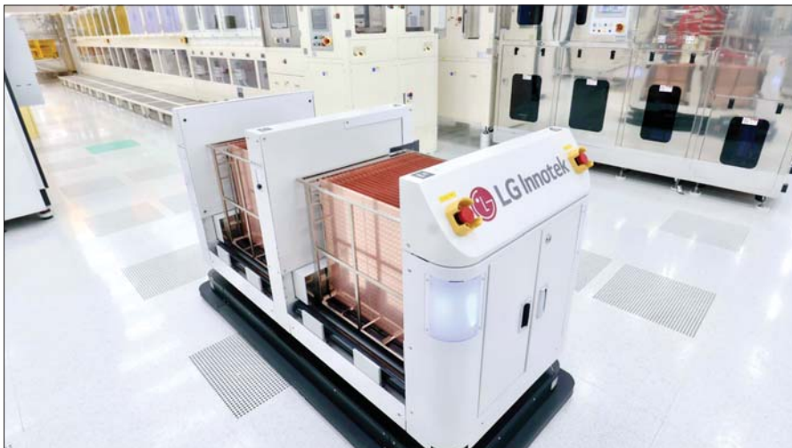
경북 구미 ‘드림 팩토리’ 내 FC-BGA 생산에 필요한 원자재를 나르는 AMR 자율주행 로봇.
